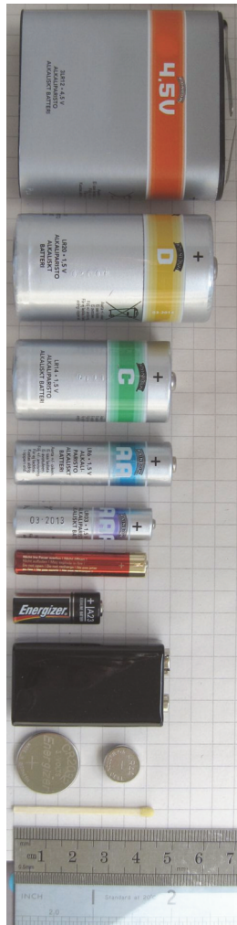
Fig. 3.4 – Vari tipi di batterie: da sinistra, batteria da 4,5 volt, torcia (D), mezza torcia (C), stilo (AA), mini stilo (AAA), A23, 9 volt, e due pile a bottone.
