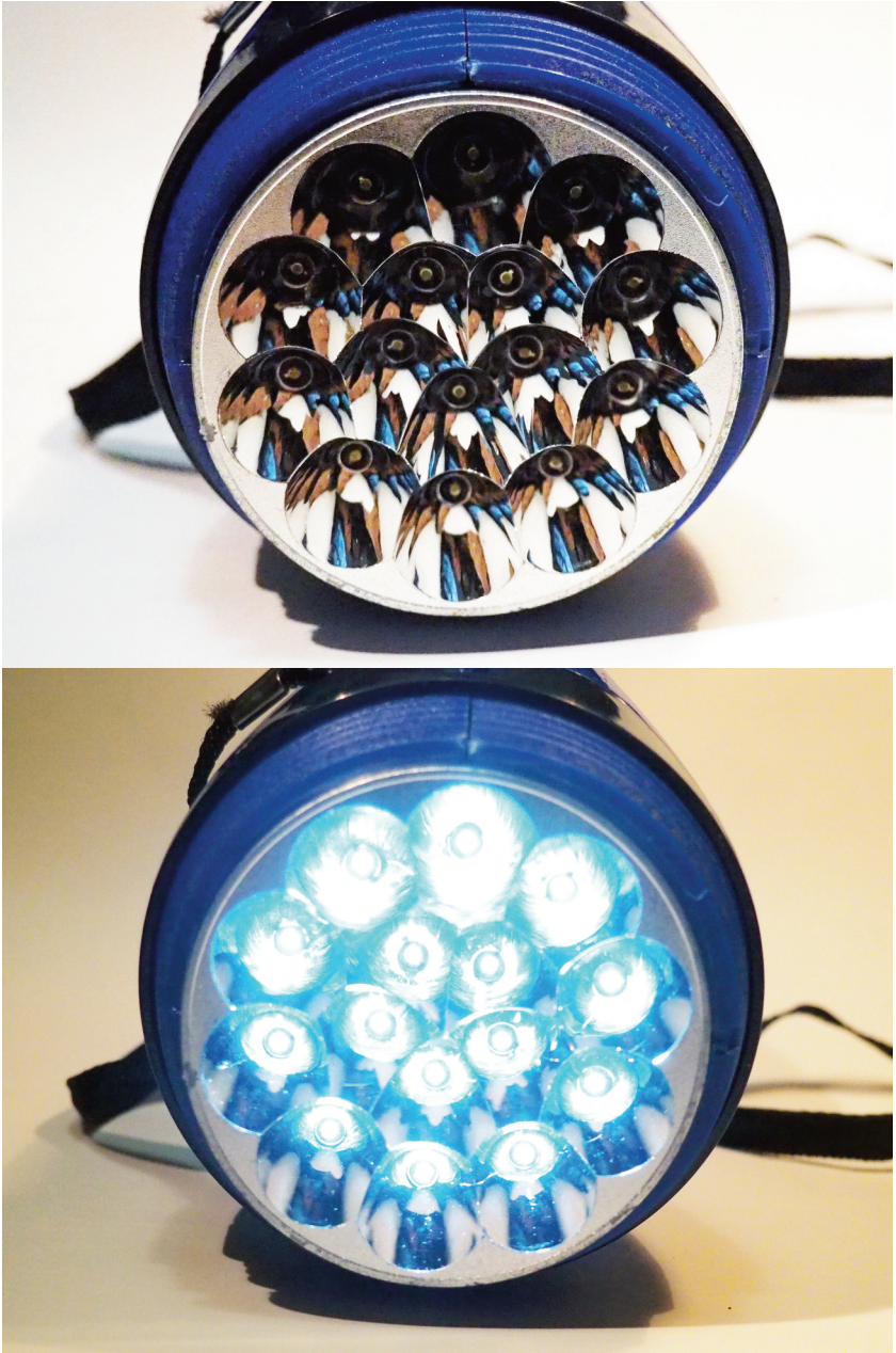
Fig. 3.10 – Configurazione ottica con più Chip LED.
