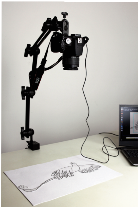
Fig. 4.42 – Fotocamera reflex sostenuta da braccio per luci, attaccato al tavolo con morsetto.
