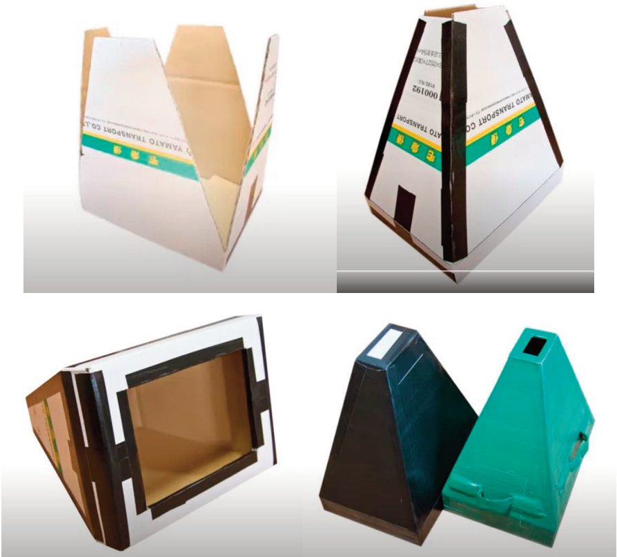
Fig. 6.4 – Passaggi per la costruzione di un box per stencil.
